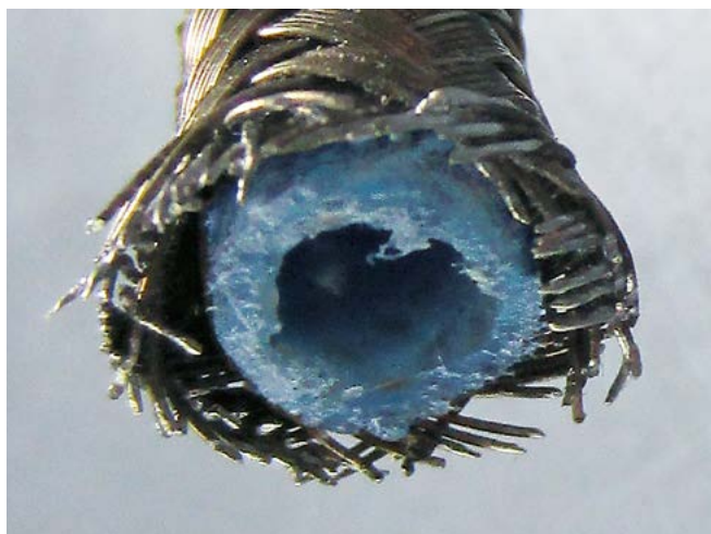
ADDINOL Cliptec XHS sari – sadestisteta õlituru, täiesti läbitav / Линейка ADDINOL Cliptec XHS — маслоподающая трубка без отложений полностью сохраняет пропускную способность
