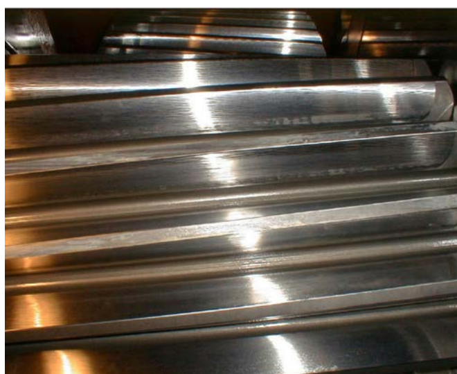
Foto 1: Eco Gear peatab edukalt mikropitingu leviku. Õli hoiab ära suuremad kahjustused ja pikendab olulisel määral reduktori tööiga.
