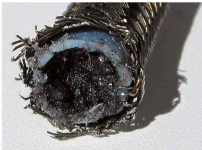
Konkurendi toode – sadestistega ummistunud õlituru Конкурирующий продукт — маслоподающая трубка закупорена отложениями
